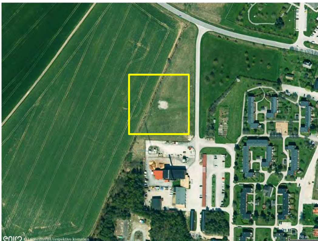
Figur 6 Möjlig placering av 3 000 m 2 solfångare i anslutning till fjärrvärmecentralen i Hemse. Kvadraten motsvarar 10 000 m 2 .
